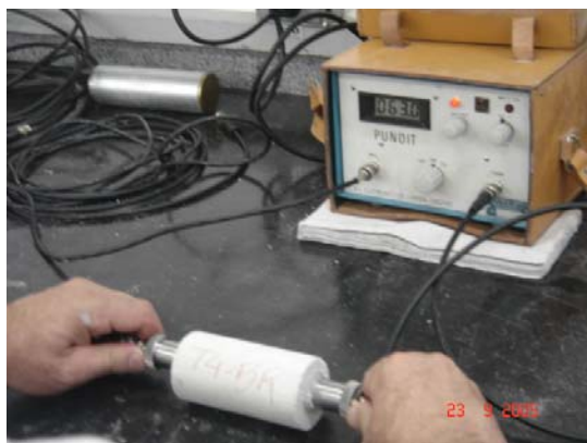
Figura 1 – Determinação do tempo que a onda ultra-sônica percorre o corpo de prova 5x10 cm
