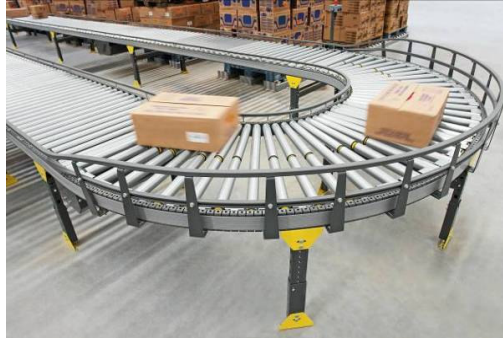
Figura 10: Curva de Rolos Acionados para Transportador
